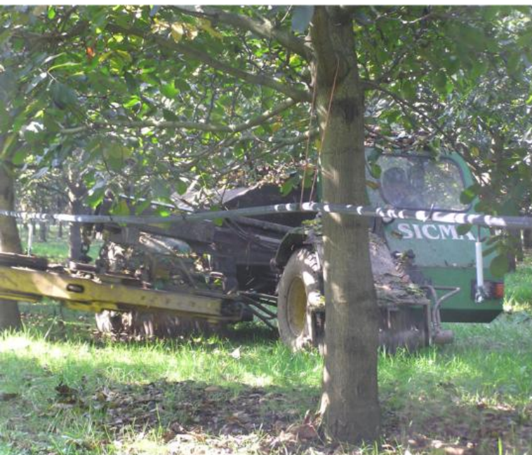
Fig. 13 - Macchina scuotitrice di tronco per vibrazione.
